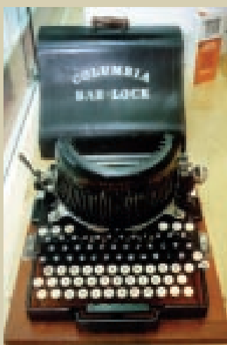
Máquina de escrever Columbia Bar-Lock - Modelo 10, sistema mecânico, teclado duplo, Inventor Charles Spiro, USA, 1899
